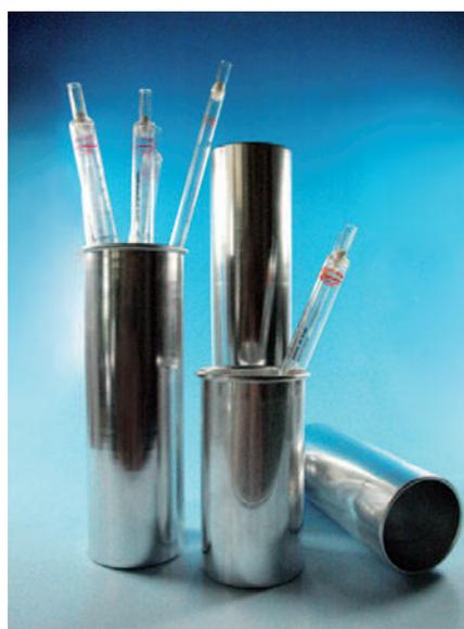
Consiste en dos partes variables de aluminio que se superponen para que las pipetas de diferente longitud/volumen puedan ser esterilizadas y almacenadas.
