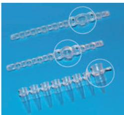
Fabricados en polipropileno puro y virgen, libres de RNasa, DNasa y ADN. Autoclavables a 121 °C (2 bar), según DIN EN 285.
