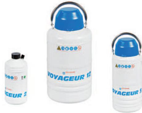
Los contenedores de la serie VOYAGEUR están especialmente diseñados para el transporte de muestras biológicas. El nitrógeno líquido es absorbido en una sustancia porosa, de modo que el almacenamiento de las muestras tiene lugar en la fase gaseosa e incluso en un posible accidente, ningún nitrógeno líquido puede filtrarse o salpicar.
