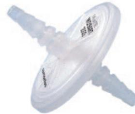
Para la ventilación estéril de fermentadores, recipientes de cultivo, etc. o para actuar como barrera de agua entre el matraz de succión y la bomba de vacío en aplicaciones de filtración. La membrana de PTFE soportada dentro de una carcasa de PP proporciona una excelente resistencia química. Filtrar en ambos sentidos (presión máxima de 3 bar).
