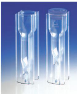
Fabricadas en plástico para el rango UV/VIS. Para medidas de 230 a 900 nm.
