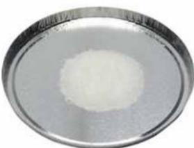
Platillos para muestras de aluminio de alta calidad, para la determinación de humedad.
