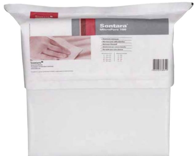
Diseñados para sala limpia. No se utilizan aglutinantes ni tratamientos químicos en su fabricación. La elevada limpieza y pureza se garantizan por un contenido iónico y un nivel extraíble mínimos así como por una generación de partículas extremadamente baja por parte de la propia materia. Los estilos de tejido ofrecen una absorción de partículas y líquido elevada debido a su contenido en celulosa.
