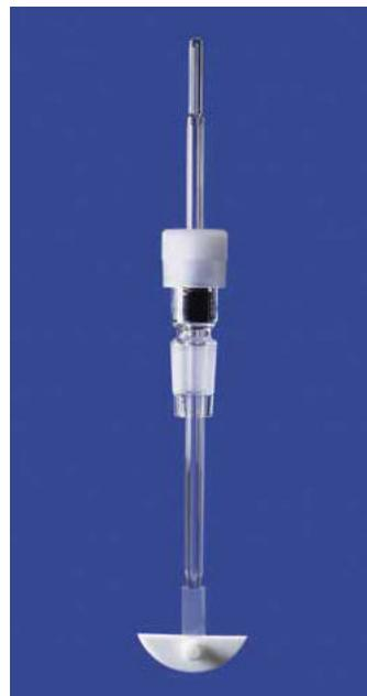
Fabricado a partir de tubo DURAN®. Para matraces redondos de 250 - 2000 ml. Eje agitador, con pala agitadora y rosca de seguridad de PTFE. Cierra los aparatos de agitación al vacío herméticamente al gas hasta 10<sup>-3</sup> mbar hasta una carga permanente de 800 rpm.
