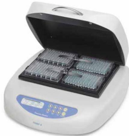
El PHMP es una incubadora que agita microplacas a temperatura y velocidad variables con una excelente uniformidad de la temperatura en toda la microplaca. La tapa y la base calefactora patentadas que cubren por completo la placa crean un microambiente controlado. Esto combinado con una agitación orbital potente da lugar a un rendimiento máximo de las incubaciones.
