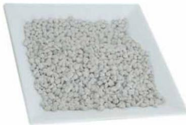
Específicamente para trabajos analíticos. Pueden ser utilizadas para la destilación en un ambiente limpio, neutro y básico. No aptas para destilación al vacío. Efectivas en las cantidades más pequeñas de líquido, también después de destilaciones múltiples. Evitan los choques. Producto cerámico con un nivel relativamente alto de pureza y resistencia a la abrasión.
