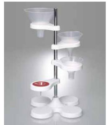
Blancos, irrompibles, resistentes a químicos. Para 2 o 4 embudos. Base robusta y pesada, lo que les proporciona una buena estabilidad. Soporte ajustable a diferentes alturas hasta los 450 mm. Gracias a los imanes no son necesarios los tornillos de sujeción. La altura del soporte del embudo se puede ajustar con facilidad y flexibilidad con una mano.
