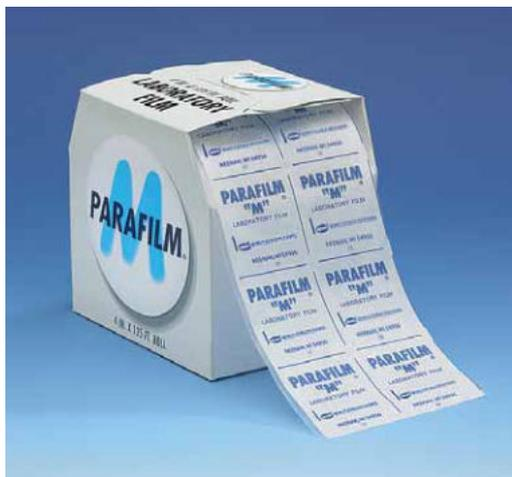
Se estira hasta el 200 % de su tamaño normal y se adapta casi siempre a cualquier forma y superficie irregular. PARAFILM® M resiste durante 48 h sustancias polares como soluciones salinas, ácidos inorgánicos y bases. PARAFILM® M cumple los requisitos generales de la FDA si se utiliza por debajo de los 55 °C.
