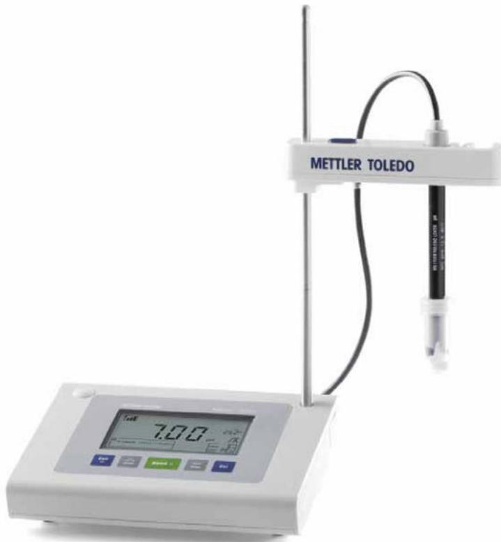
Los medidores de sobremesa FiveEasy™ proporcionan mediciones de pH/mV de alta calidad con el simple click de un botón.
