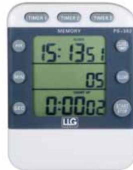
El temporizador LLG Triple pro ofrece tres temporizadores separados en un solo instrumento. Se puede almacenar un tiempo por canal. Este temporizador puede ser usado simultáneamente como reloj de tiempo real y temporizador. El temporizador de cuenta atrás también funciona cuando el tiempo es visible.
