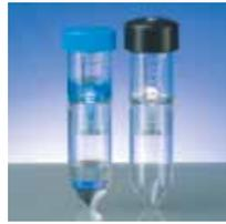
Membrana: polietersulfona. Vivaspin 20 maneja hasta 20 ml en centrífugas de cubo oscilante y 14 ml en rotores de ángulo fijo de 25° que aceptan tubos de centrifuga de 50 ml. Al contar con membranas verticales dobles para lograr velocidades de filtración sin precedentes, el Vivaspin 20 puede alcanzar concentraciones de más de 100x.
