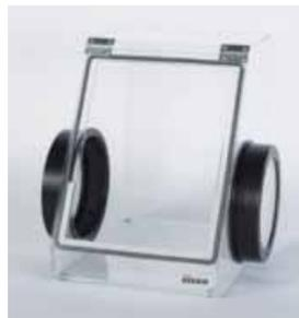
Para facilitar el manejo de pequeñas cantidades en un espacio de trabajo cerrado. Fácilmente transportable debido a su peso ligero. Paneles y panel base de vidrio acrílico, con orificios para guantes laterales con puertos Iris (uno en el lado derecho, otro en el lado izquierdo). Los puertos Iris pueden ser fácilmente intercambiados por puertos de guantes estándar con un diámetro de 190 mm para permitir un sellado hermético.
