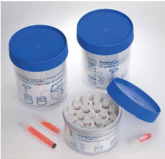
Con tapa de rosca de 120 mm de diámetro en HDPE azul, soporte para frascos de HDPE blanco. Adecuado para 18 crioviales de 1,2/2,0ml. Interior de espuma. Velocidad de enfriamiento 1°C/min. Los tubos se pueden quitar fácilmente. Cada abertura tiene un número moldeado para su identificación. Apilable.
