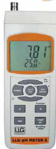
El valor pH y la temperatura se pueden memorizar directamente en la tarjeta SD (archivo Excel) o transferir directamente desde el pHmetro a un PC a través de la interfaz RS-232.
