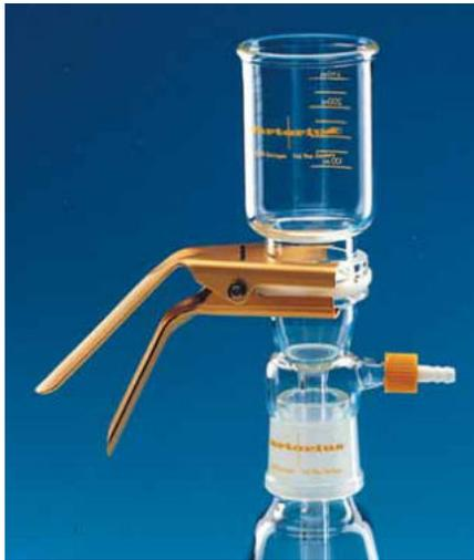
Para la filtración al vacío de partículas de soluciones. Se compone de un colector superior desmontable de 250 ml con soporte para filtro y abrazadera. Para filtros de 47 mm y 50 mm de diámetro. Se suministra completo con un matraz de filtro de 1 L de capacidad con junta esmerilada para encajar en el colector y un brazo lateral de PP para una conexión segura de los tubos flexibles de vacío.
