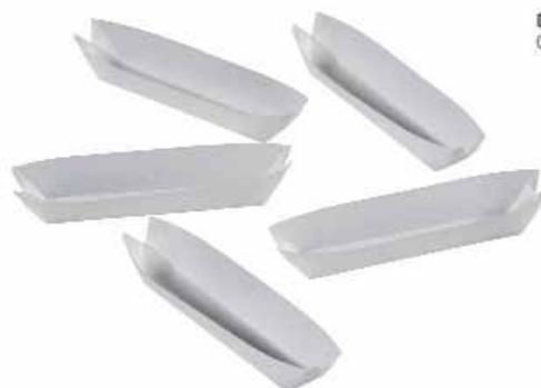
Especialmente para la determinación de nitrógeno según Kjeldahl (p. ej. determinación del contenido total de proteínas en alimentos). Hechos de papel pergamino libre de nitrógeno. Pueden colocarse en el matraz Kjeldahl y disolverse junto con la muestra.
