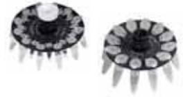
Centrífuga/ mezclador vórtex combinado para microtubos y tiras de 0,2 ml. Para la centrifugación independiente y la mezcla en vórtex, o la mezcla de un tubo individual simultáneamente con el centrifugado de múltiples tubos. La copa vórtex, situada en la parte superior del eje central, emerge a través de una abertura en la tapa cerrada.
