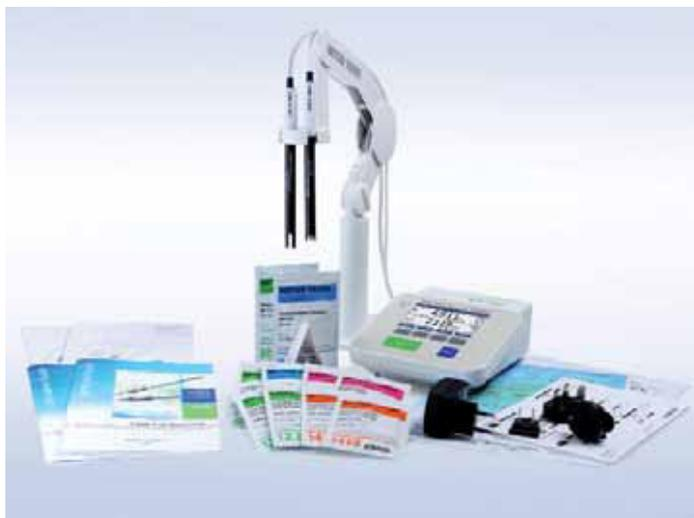
Medidor universal compacto de dos canales para medir el pH y la conductividad, así como la resistividad, la salinidad y el TDS.
