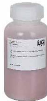
Con indicador de color naranja. El gel es naturalmente de color naranja cuando está activo y a un nivel de saturación del 6 % del peso. A medida que el gel absorbe la humedad, el color cambia a oscuro. El gel se puede regenerar cuando se calienta a una temperatura máxima de 120 °C hasta que recupere su color naranja original.
