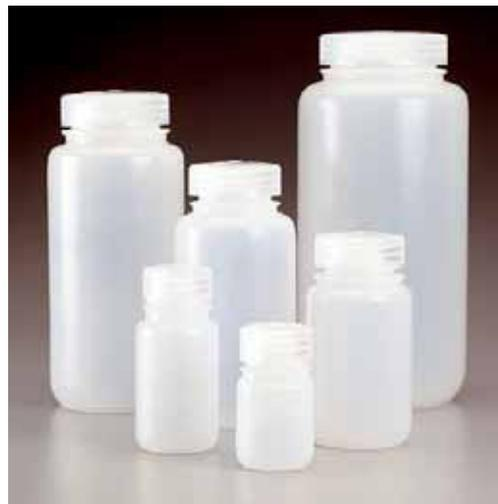
Frasco económico y de construcción robusta. Garantizado a prueba de fugas para una toma de muestras, transporte y almacenamiento seguros. El frasco traslúcido permite ver el nivel de líquido. Material del frasco de muestra especificado por la EPA para una amplia variedad de compuestos inorgánicos y análisis elementales.
