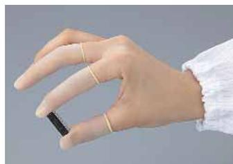
Protectores para los dedos de caucho natural antiestático, con un espesor de mín. 0,09 mm, ideales para aplicaciones en las que se requiere una precisión y sensibilidad elevada de los dedos. Son muy útiles gracias a la microtexturación.
