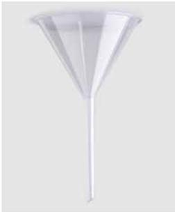
Fabricados en polipropileno virgen transparente, esterilizables en autoclave a 121 °C y 1,1 bar durante 30 minutos.
