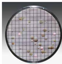
Discos para cultivo estériles y deshidratados en placas de Petri. Una vez que se humedecen con 3,0 ml a 3,5 ml de agua estéril y desmineralizada (o destilada), están listos para usar inmediatamente. Todos los medios de cultivo se suministran con filtros de membrana adecuados, envasados individualmente y estériles. Vida útil de entre 18 y 24 meses a temperatura ambiente.
