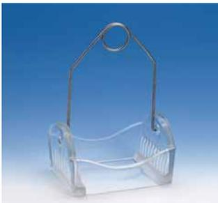
Sostiene portaobjetos de microscopio de 76 x 26 mm a 50 mm.
