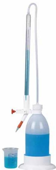
Bureta según Dr. Schilling con protección contra astillas, con tiras Schellbach, extracción automática del punto cero y dosificador Bürkle.
