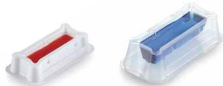
Depósitos de reactivos desechables con fondo en forma de V para garantizar que todo el reactivo sea accesible y pueda aspirarse fácilmente. La construcción de pared gruesa y base ancha añade estabilidad y durabilidad haciendo que el depósito sea fácil de manejar sin deformación del producto.
