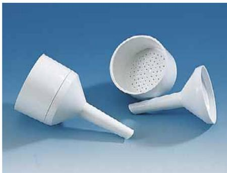
PP. Construcción de dos piezas. Las secciones superior e inferior pueden ser separadas. Fáciles de limpiar. Autoclavables. Aptos para uso alimentario.
