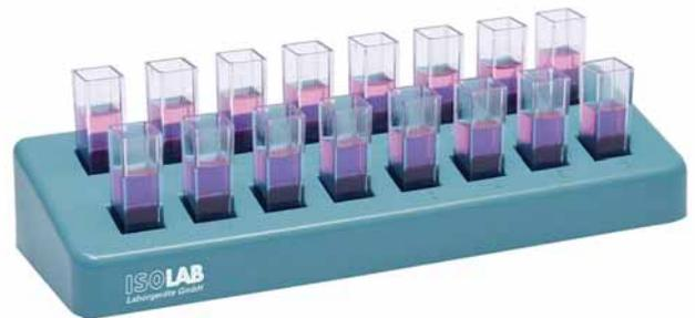
Para el manejo y la sujeción seguros de 16 cubetas de espectrofotómetro con un ancho de 10 mm. El índice alfanumérico en las filas de cubetas permite una fácil identificación de las posiciones de los tubos. La forma del cuerpo de 2 hileras ofrece una opción de visibilidad clara desde la dirección horizontal. Autoclavable (121 °C).
