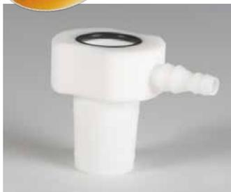
Para el montaje seguro de embudos de filtro estándar de vidrio o plástico en botellas de laboratorio. Con conector lateral de manguera de 2 pasos para la conexión a una bomba de vacío. Paso con junta tórica de FKM. Conforme a la FDA. Resistente a los químicos. Autoclavable.
