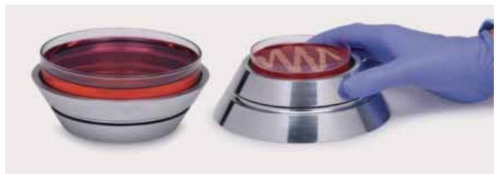
La plataforma giratoria de accionamiento manual permite una rotación suave y uniforme en ambas direcciones para una distribución fácil y rápida de las bacterias en la superficie de la placa Petri. Gracias a su diseño de doble cara, la plataforma giratoria puede alojar placas Petri de 60 a 150 mm de diámetro. Soporte antideslizante.
