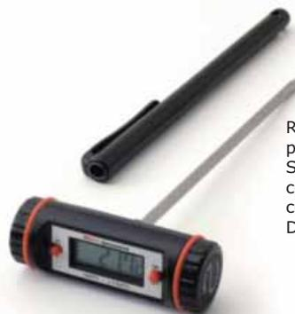
Rango de medición de -50 a +150 °C, precisión ±1 °C. Con función de retención. Sonda de acero inoxidable, 125 x 3,5 mm, con funda protectora de plástico y clip, con una batería de 1,5 V (LR44). Dimensiones (L x An): 60 x 20 mm.
