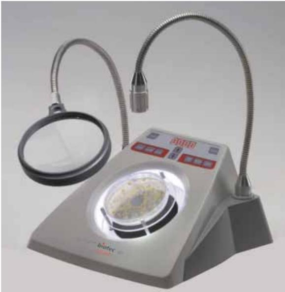
Diseñado para el recuento fiable y eficiente de las colonias de bacterias y placas de bacteriófagos que crecen en el agar nutritivo o discos nutritivos/discos filtrantes en las placas de Petri. Proporciona un trabajo ergonómico y relajado.
