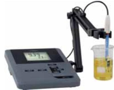
Instrumento básico de laboratorio de pH/mV para todas las tareas que requieran lecturas fiables y precisas. Con pantalla de segmentos LCD de gran tamaño y teclado de fácil lectura. La función AutoRead garantiza resultados de medición correctos y repetibles. Un temporizador incorporado recuerda al usuario la calibración periódica.
