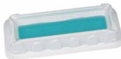
Fabricados en poliestireno. Los lados angulados y el fondo en forma de V permiten la máxima recuperación de reactivos. Todos los depósitos tienen líneas de volumen graduadas internas y picos de vertido en las esquinas. Versiones de 25 ml o 50 ml. Disponibles en versiones estériles y no estériles.
