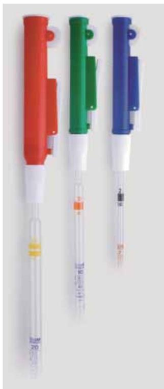
La rueda manual permite la aspiración precisa del líquido en la pipeta con una sola mano. Cuando la rueda se detiene, el pistón permanece en la posición deseada. El líquido puede expulsarse presionando el pistón hacia atrás o dejándolo salir ajustando el interruptor lateral en "Ex".
