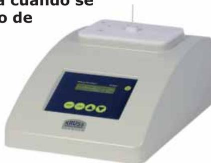
**Material de suministro:** Medidor del punto de fusión, cubierta protectora, 100 capilares
