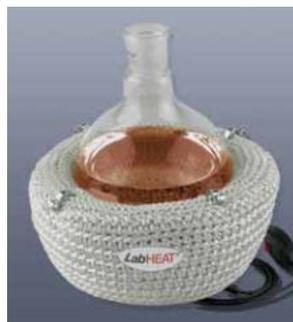
Mantas calefactoras LabHEAT® para matraces, fondo redondo. Elemento calefactor de hilo de vidrio flexible, camisa exterior de seda de vidrio, con diám. 60 mm de salida de fondo a partir de 500 ml, temperatura máxima del elemento calefactor 450 °C, cable de alimentación de 1,5 m (conectado a tierra) con interruptor de zona calefactora y RCD (detección de corriente residual), tensión nominal 230 V AC.
