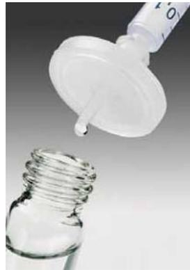
Carcasa PP. Celulosa regenerada (RC). Unidades listas para usar con una membrana hidrófila, resistente a los disolventes, hecha de celulosa regenerada, lo que hace que la preparación de la muestra sea rápida y fácil. Adecuados para soluciones acuosas/orgánicas. Luer Slip macho.
