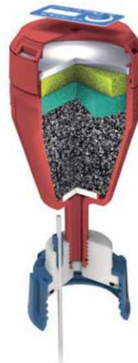
Los filtros de aire de escape están equipados con tres capas diferentes de carbón activado, que aglutinan los ácidos y álcalis y adsorben los vapores de los disolventes orgánicos. Dependiendo de la capacidad requerida, hay disponibles filtros con diferentes vidas útiles.
