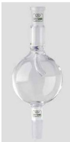
Adecuado para ser usado en montajes de destilación para evitar que el líquido crudo pase del matraz al condensador.
