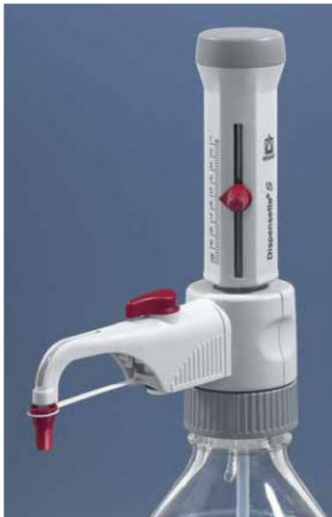
Código de color rojo. Amplia gama de aplicaciones, ideal para dosificar reactivos agresivos, por ejemplo, bases y ácidos concentrados como H<sub>3</sub>PO<sub>4</sub>, H<sub>2</sub>SO<sub>4</sub> (excepto HCl, HNO<sub>3</sub> y HF), soluciones salinas y una variedad de solventes orgánicos.
