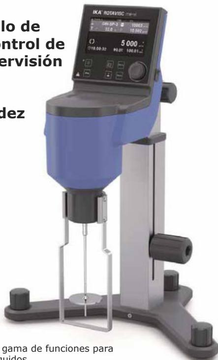
Viscosímetros con una amplia gama de funciones para determinar la viscosidad de líquidos.
