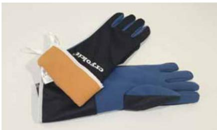
Adecuados para trabajar con nitrógeno líquido y otros gases criogénicos hasta aprox. -196 °C. Protegen contra quemaduras por contacto y frío en caso de fugas de gas líquido. Son guantes impermeables hechos de un tejido especial elástico y laminado. Aislamiento interior: tela de poliéster multicapa (410 g/m<sup>2</sup>) y membrana de porelle de poliolefina. Según normativa EN 511, EN 420, EN 388, Cat III.
