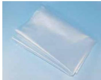
Fabricadas con una lámina de PP muy resistente con una amplia costura en la parte inferior. Para la eliminación de material de laboratorio contaminado. Cuando se esteriliza en autoclave, el cuello de la bolsa debe quedar abierto. Espesor del film: 50 µm. Embalaje: Cartón (9.404 099 y 9.404 020 en caja dispensadora)
