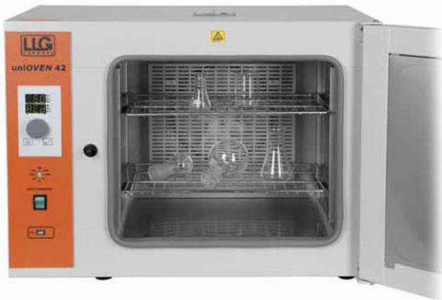
Estufa de secado universal controlado por microprocesador con **convección forzada** y dos estantes. Cada estante de los modelos uniOVEN 42 tiene una capacidad de carga de 20 kg, la capacidad de carga total de cada unidad es de 50 kg. El número máximo de estantes es de 7 para uniOVEN 42 con una distancia de 40 mm entre estantes.
