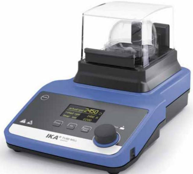
Adecuado para cámaras de molienda desechables y reutilizables. Utilizando las cámaras de molienda desechables se elimina la posibilidad de contaminación cruzada y el esfuerzo de limpieza. Los molinos se pueden utilizar para materiales duros (dureza Mohs hasta 5), secos y quebradizos. Son especialmente adecuados para la molienda de semillas, como el maíz y el trigo.
