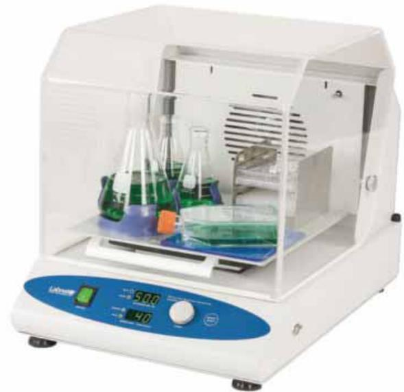
La incubadora de mesa con agitación es la combinación de agitador y cámara de temperatura, diseñada para la agitación y el tratamiento térmico de muestras sensibles. Sustituye a dos dispositivos, reduce el tiempo y el espacio necesarios. Es muy adecuada para laboratorios de bioquímica, microbiología y medicina en los que el tratamiento térmico y por agitación de las muestras es una rutina de uso diario.
