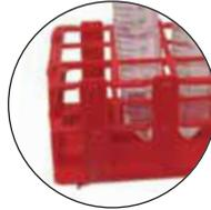
Hecha de PP. Apilable. Se suministra en tres partes y es fácil de montar. Rejilla alfanumérica referenciada en el nivel superior para una fácil identificación de las muestras. Autoclavable.
