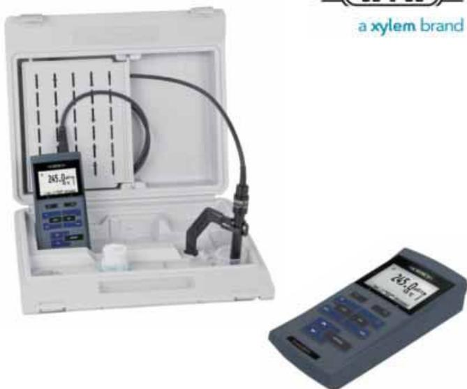
Conductímetro cómodo y versátil con registrador de datos controlado por tiempo incorporado. Con pantalla gráfica retroiluminada. Impermeable y robusto. Para medir la conductividad, la resistividad, la salinidad y el TDS. Amplia selección de celdas de medición conectables, selección ampliada de la constante de la celda, compensación automática y manual de la temperatura (también desconectable) con función lineal y no lineal para agua ultrapura y agua natural según la norma EN 27 888.
