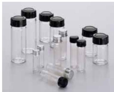
Autoclavables. Para el crecimiento del cultivo, transporte y almacenamiento. Completos con tapón de rosca de aluminio o plástico y junta de sellado de goma. El tamaño de 5 ml tiene un área de marcado esmerilada.
