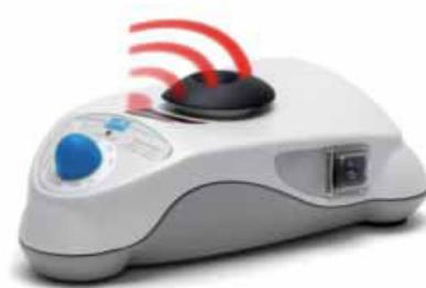
Agitadores vórtex con sensor IR patentado para el reconocimiento de muestras: el proceso de agitación se inicia automáticamente cuando el tubo de muestra se acerca al cabezal del vaso mezclador. Esto permite un trabajo sin fatiga, ya que la muestra no tiene que ser presionada en el dispositivo.
