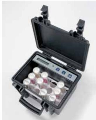
Diseñada para la incubación fiable de diptiles en laboratorios y trabajo de campo.
