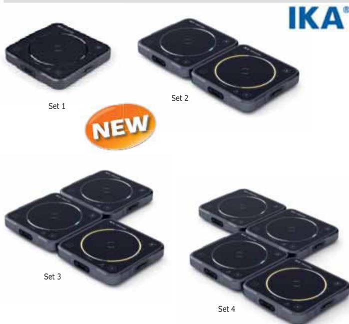
Sin calefacción. El TWISTER es un dispositivo de mezcla universal y especialmente compacto con accionamiento magnético, que puede ampliarse hasta convertirse en un agitador magnético multiposición con una amplia gama de aplicaciones mediante la conexión en serie de hasta 30 dispositivos. Los puntos de agitación pueden controlarse por separado o simultáneamente (principio de líder-seguidor).
