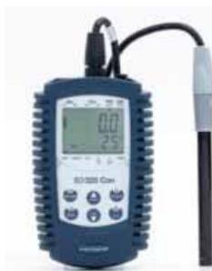
El instrumento portátil con registrador de datos es ideal para determinar la conductividad eléctrica en medios acuosos.
