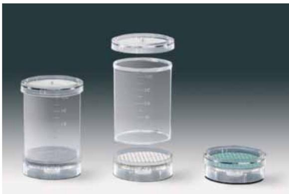
Unidad de filtración preparada para su conexión en combinación con una barra de aspiración Sartorius o para su adaptación directa en una bomba de vacío especial. Los monitores Biosart® 100 están diseñados específicamente para el análisis microbiológico de productos farmacéuticos, cosméticos, agua y otros líquidos. Tamaño de los poros: 0,45 µm
