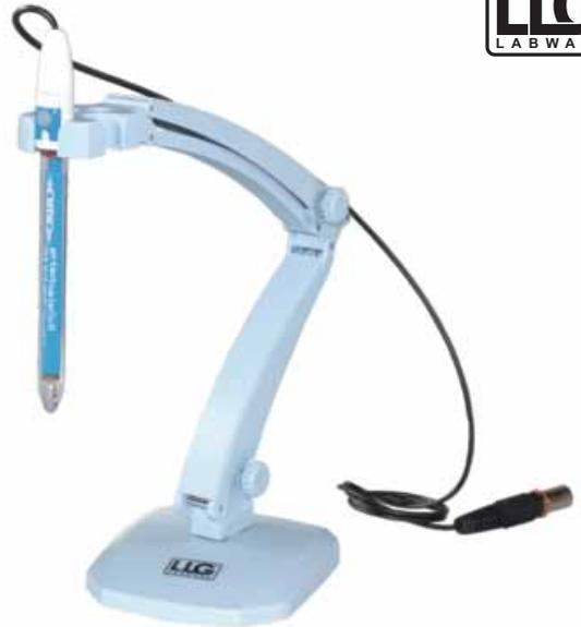
Tres aperturas con diám. 16 mm. Apertura adicional para sensor de temperatura. Tres juntas para una gran flexibilidad y opciones de ajuste.
