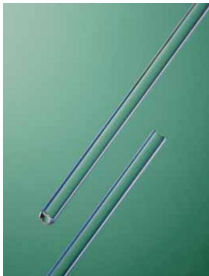
Los tubos de RMN son especialmente adecuados para mediciones de rutina, mediciones de alto rendimiento o sistemas de RMN con muestreo automático a frecuencias de medición de hasta 600 MHz. Los tubos están fabricados con vidrio de borosilicato 3.3 que se ajusta a la USP Tipo I y a la ASTM E438, Tipo I, Clase A. Pida los tapones de cierre por separado.
