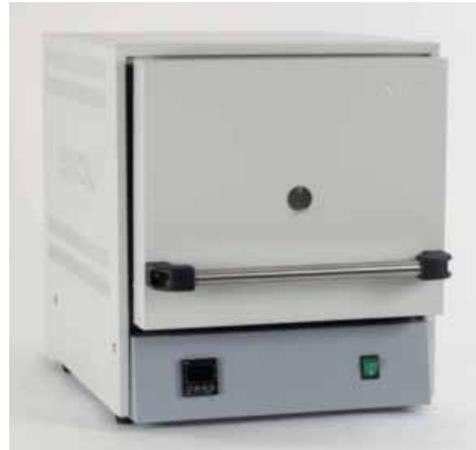
Hornos de mufla con cámaras aisladas con fibra y placas calefactoras de cerámica.
