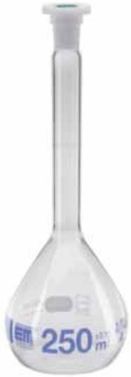
Calibrados en IN (TD). Con identificación del lote mediante fecha y declaración de conformidad según DIN 12600. Con esmerilado NS y tapón de poliestireno. Marca anular y graduación en esmaltado azul de alto contraste de acuerdo DIN EN ISO 1042.
