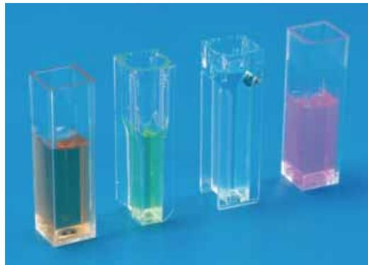
Cubetas desechables para espectroscopia fabricadas en PMMA y con un grosor de capa de 10 mm para una transmisión óptica cuando se utilizan longitudes de onda de 280 a 800 nm. El control de la forma y el control de calidad constante establecen la reproducibilidad de las cubetas. Las cubetas Kartell están sometidas a un estricto control de calidad y tienen una tolerancia de medición de  $\pm 1\%$ , lo que es muy importante para los exámenes en serie!
