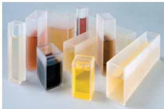
Cubetas de vidrio óptico o de vidrio de borosilicato de 3.3, 21 mm x 40 mm, para los modelos Fs, PFXi/PFX195, 880, 950 y 995. (Nota: PFXi/PFX-195 longitud máxima del recorrido 50 mm).
