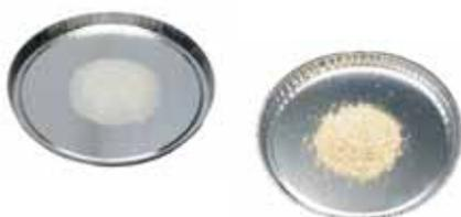
Platillos para muestras de aluminio de alta calidad, para la determinación de humedad.
