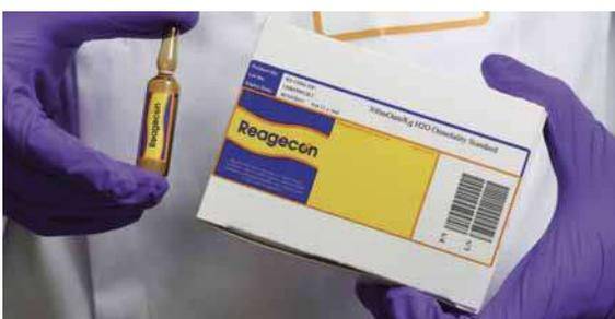
Estándares de osmolaridad para la calibración y el control, compatibles con todos los tipos de osmómetros. ISO 17025. Valores de 100 a 700 mOsmol/kg H<sub>2</sub>O según la Farmacopea Europea 2.2.35 y la Farmacopea Americana 785. 12 ampollas de 5 ml cada una.
