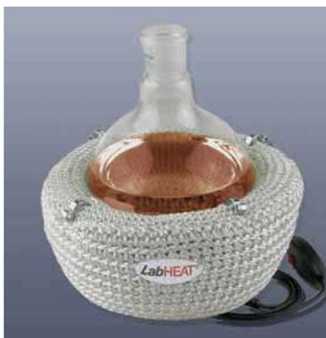
Mantas calefactoras LabHEAT® para matraces, fondo redondo. Elemento calefactor de hilo de vidrio flexible, camisa exterior de seda de vidrio, con diám. 60 mm de salida de fondo a partir de 500 ml, temperatura máxima del elemento calefactor 450 °C, cable de alimentación de 1,5 m (conectado a tierra) con interruptor de zona calefactora y RCD (detección de corriente residual), tensión nominal 230 V AC.
