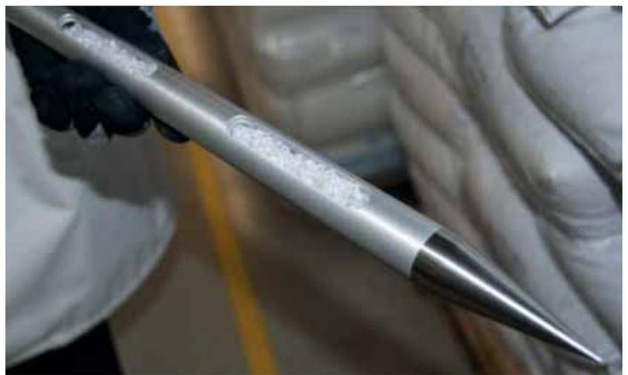
Para la toma de muestras de mercancías a granel de todo tipo. Con tubos internos abiertos para el muestreo transversal a través de todas las capas de la muestra. Vaciado a través del extremo abierto del tubo del muestreador. Diámetro del tubo: 25 mm.
