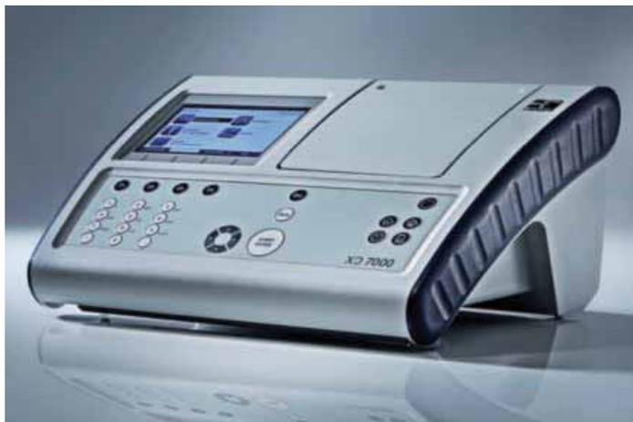
Espectrofotómetros UV-VIS y VIS con óptica de doble haz. Otras funciones de los espectrofotómetros incluyen la medición de la transmisión y la absorbancia, el escaneo de espectros, el análisis cinético y la creación de métodos definidos por el usuario.
