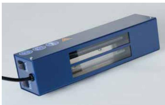
2 x 6 W Lámpara de análisis con dos tubos UV conmutables por separado de alta intensidad de radiación. El tubo UVA produce radiación de onda larga a 365 nm y el tubo UVC radiación de onda corta a 254 nm. Ideal para aplicaciones químico-analíticas y para el control de la higiene.
