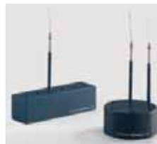
**Asas de inoculación** a base de acero inoxidable, cable especial de acero inoxidable o alambre de platino iridio (90/10) . Puede calentarse al rojo vivo. Longitud: 60 mm . Diámetro del alambre: 0,5 mm.
