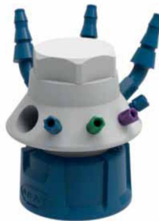
Tapa de seguridad para residuos para conectar 4 capilares (UNF 1/4" 28 G), 3 conectores de tubo (NPT 1/8") y un filtro de escape (GL 14). Con tapa de libre movimiento para un cambio sencillo del recipiente.
