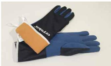
Adecuados para trabajar con nitrógeno líquido y otros gases criogénicos hasta aprox. -196 °C. Protegen contra quemaduras por contacto y frío en caso de fugas de gas líquido. Aislamiento interior: tela de poliéster multicapa (410 g/m<sup>2</sup>) y membrana de porella de poliolefina. Según normativa EN 511, EN 420, EN 388, Cat III. Advertencia: no están preparados para la inmersión en nitrógeno líquido u otros líquidos criogénicos.
