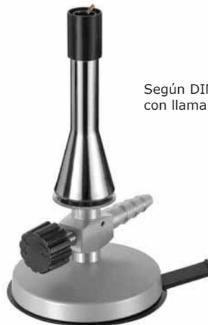
Según DIN 30665, con regulación de aire, con llama baja.
