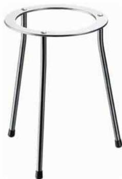
De acero galvanizado. Con la parte superior circular y las patas acampanadas. El galvanizado del trípode sirve como protección temporal contra la corrosión. Puede despegarse después de contacto directo con la llama de un quemador.
