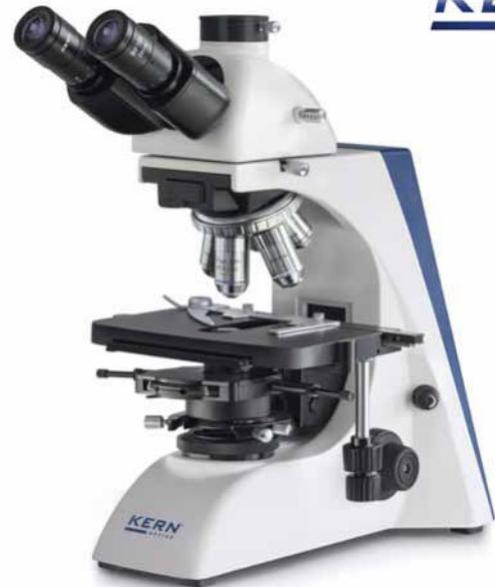
Esta serie dispone de iluminación Köhler profesional con diafragma de campo ajustable y óptica Infinity. Se requiere un adaptador de montura C para conectar una cámara (opcional).
