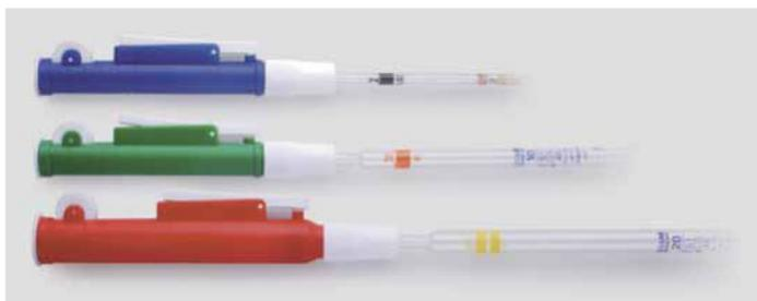
La rueda manual permite la aspiración precisa del líquido en la pipeta con una sola mano.
