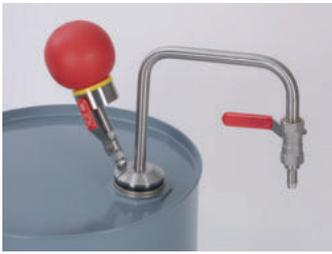
Para la extracción libre de contaminación de disolventes orgánicos y agentes aromatizantes. Se puede cerrar completamente con dos válvulas de bola para que no puedan escapar vapores peligrosos después de dispensar. La carga electrostática se puede disipar a través del juego de accesorios antiestáticos (pedir por separado).
