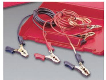
Cuando se dispensan líquidos combustibles/explosivos en la bomba, tanto el barril de dispensación como el de llenado que intervienen en el proceso deben estar suficientemente conectados a tierra, a fin de evitar la ignición o la explosión por descargas electrostáticas. Set antiestático, incluye tres cables de conexión codificados por colores con pinzas, suministrados completos en estuche de plástico.
