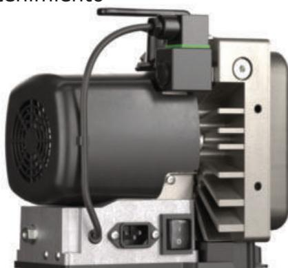
La bomba de vacío de compresión en seco y exenta de aceite funciona según el principio de un compresor scroll y combina una alta velocidad de bombeo con un buen vacío final. Ideal para pequeños laboratorios y aplicaciones de investigación y desarrollo. La válvula de escape integrada ofrece una protección eficaz contra un rápido aumento de la presión en caso de corte de corriente.
