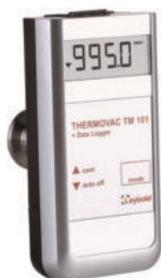
El vacuómetro con compensación de temperatura se utiliza para medir la presión absoluta. Puede utilizarse como manómetro portátil o como instrumento integrado de forma permanente en un sistema. La función de memoria integrada almacena hasta 2000 valores medidos.
