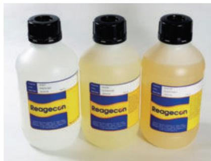
Estos patrones de color pueden utilizarse para calibrar, controlar, calificar o validar los instrumentos de medición de color para determinar el número de color. Estos estándares pueden describirse como color Platino-Cobalto, Pt-Co, Hazen o APHA. Todas las descripciones son intercambiables.
