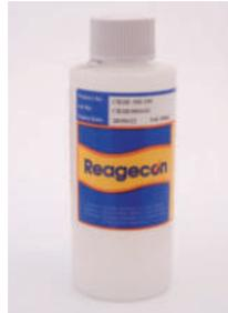
Estándares de turbidez de alta precisión compuestos de microesferas suspendidas, adecuados para la calibración de instrumentos y el control de todos los turbidímetros. Estables, con una vida útil de 2 años (desde la fecha de fabricación). Trazables al NIST, aprobados por la EPA de los EE.UU. y testados en conformidad con la ISO 7027. Botellas de HDPE de 100 ml.
