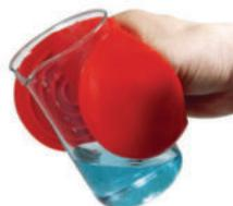
Pinza de caucho de silicona roja. Adecuada para temperaturas de -50 °C a 250 °C. Dos aberturas de agarre para un uso rápido y sencillo. Talla única, utilizable por ambos lados. Con superficie de agarre antideslizante.
