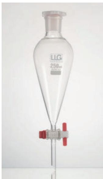
Embudo de separación con llave de paso de PTFE.
